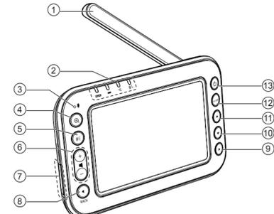
1. Antenne kantel deze naar boven voor het beste bereik
