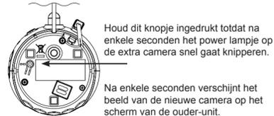
Houd dit knopje ingedrukt totdat na enkele seconden het power lampje op de extra camera snel gaat knipperen.
